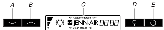
A. Diminution de la puissance B. Augmentation de la puissance C. Affichage D. Éclairage E. Minuterie
